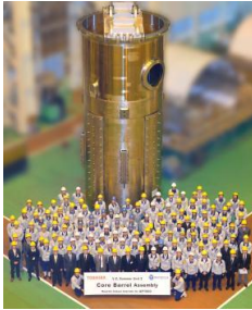
コアバレル（炉内構造物）
