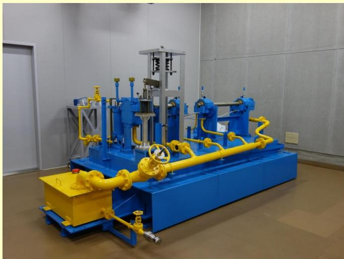
タービン動補助給水ポンプ模擬装置外観
